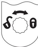
Φορά περιστροφής του πολυγωνικού κλειδιού για τη αφαίρεση/σταθεροποίηση της βίδας σύσφιξης του πριονόδισκου
