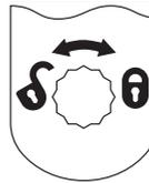
Напрямок обертання кільцевого ключа для ослаблення/затягування затискного гвинта пиляльного полотна
